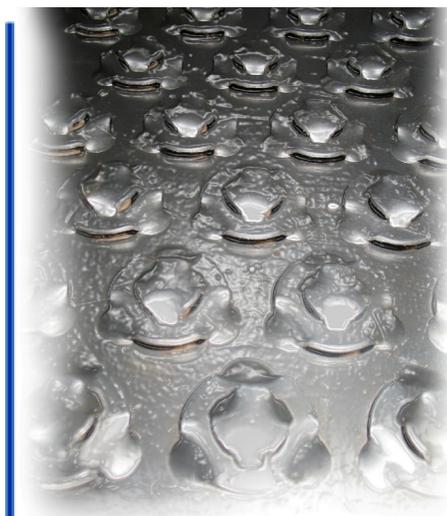
Тарелка с фиксированными клапанами
